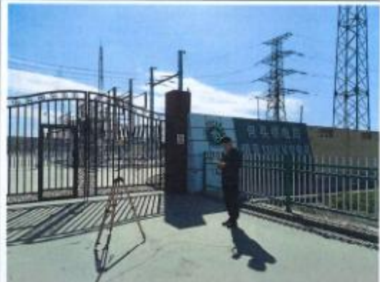
明登变电站大门口电磁检测
