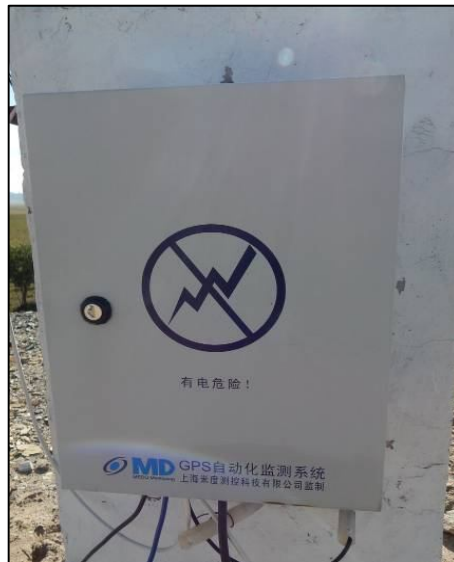
坝体 GPS 自动化监测装置
