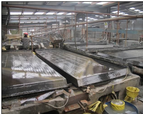
摇床安装在封闭车间内
